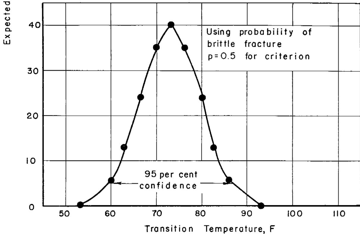
FIGURE II. COMPARISON OF DISPERSION OF TEAR-TEST TRANSITION TEMPERATURES BASED ON TESTING 20 SAMPLES
