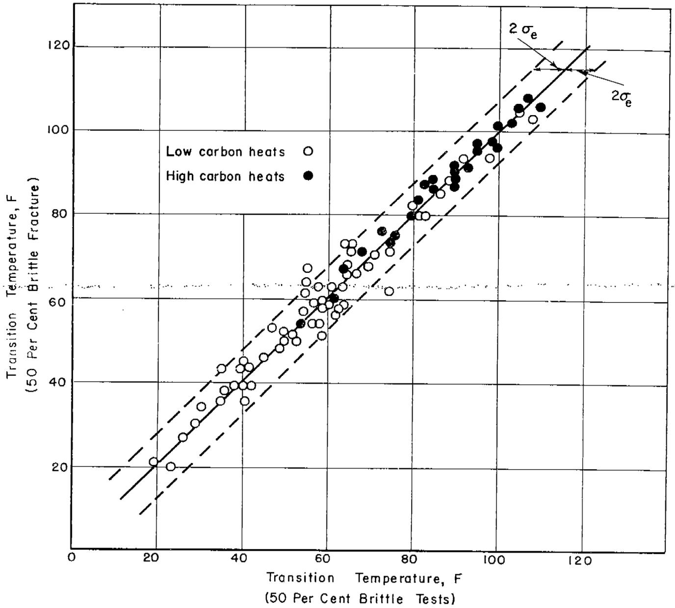
FIGURE 12. COMPARISON OF TEAR-TEST TRANSITION-TEMPERATURE CRITERIA
