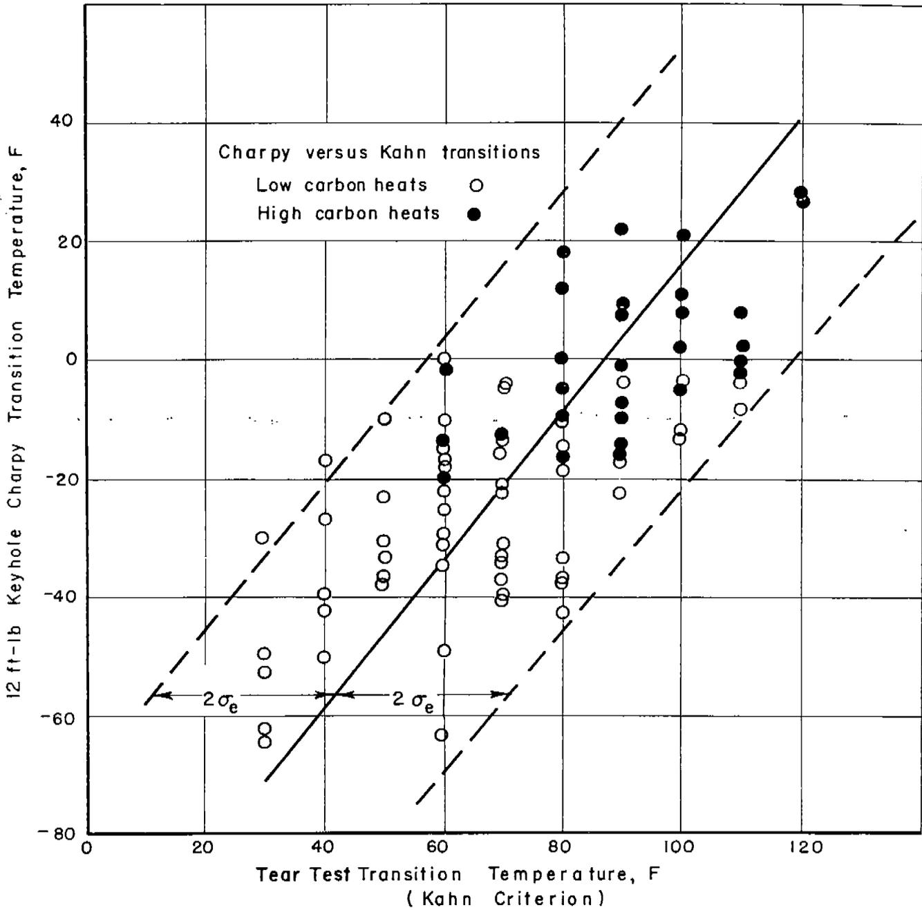
FIGURE 14. POOR CORRELATION BETWEEN TRANSITION TEMPERATURES ESTABLISHED BY CHARPY AND TEAR TESTS USING THE KAHN-IMBEMBO CRITERION
