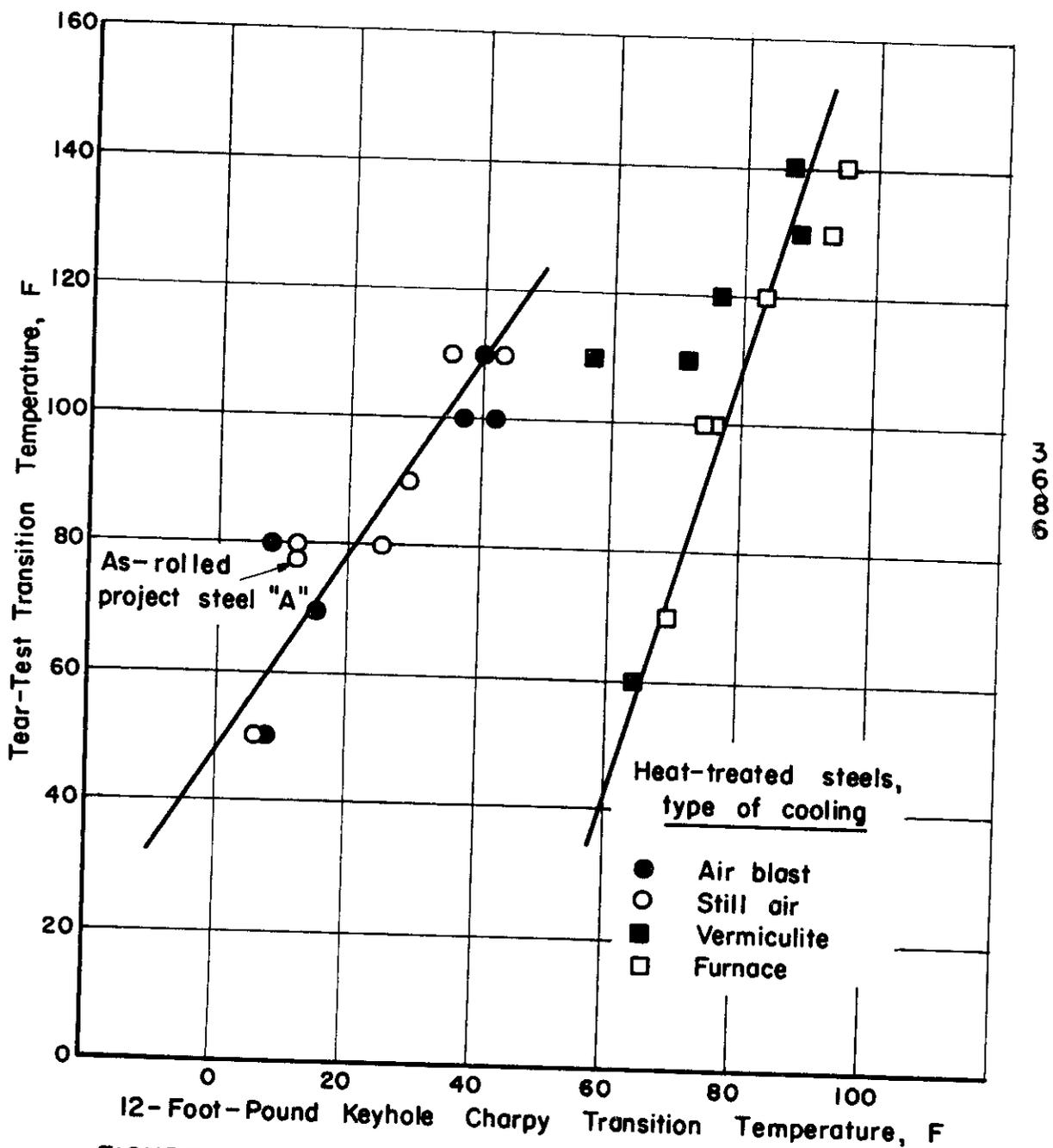
FIGURE 13. COMPARISON BETWEEN TEAR-TEST TRANSITION TEMPERATURES AND 12-FOOT-POUND KEYHOLE CHARPY TRANSITION TEMPERATURES OF A HEAT-TREATED SHIP PLATE STEEL
