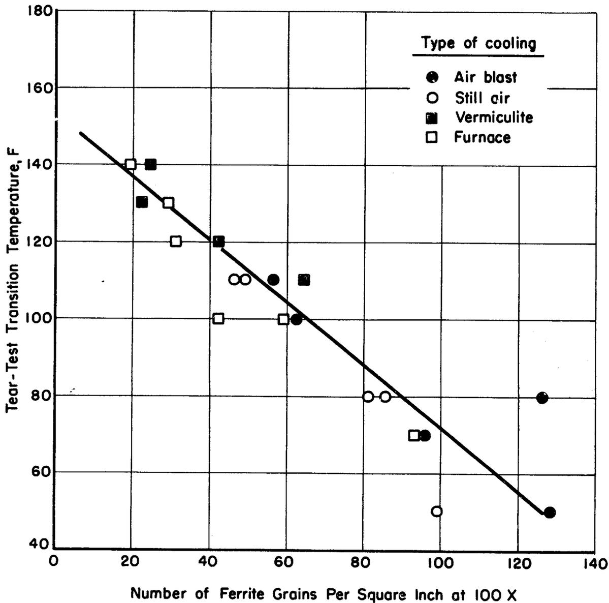
FIGURE 10. EFFECT OF FERRITE GRAIN SIZE ON TEAR-TEST TRANSITION TEMPERATURE
