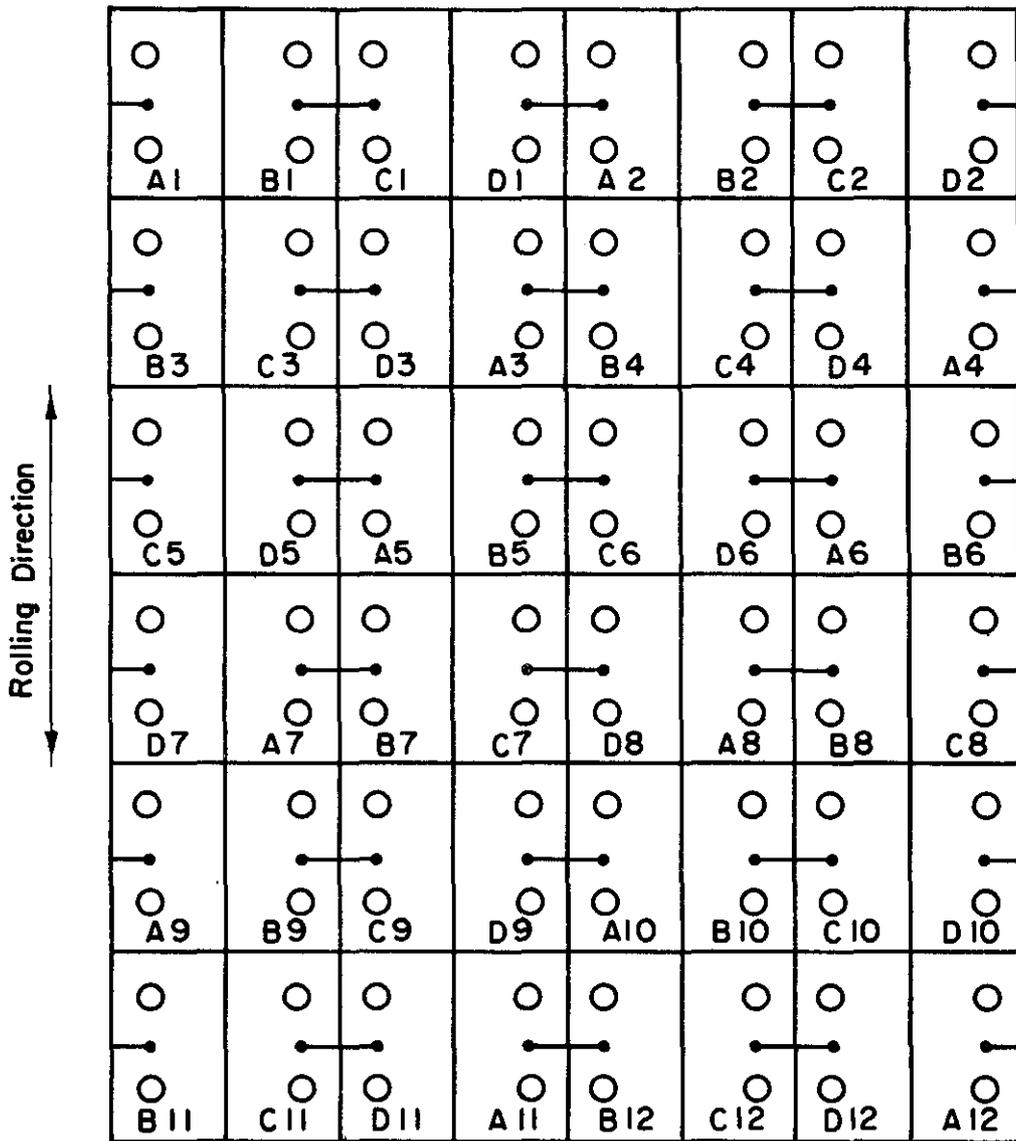
FIGURE 1. LOCATION OF TEAR-TEST SPECIMENS FROM AS-ROLLED PROJECT STEEL "A"
