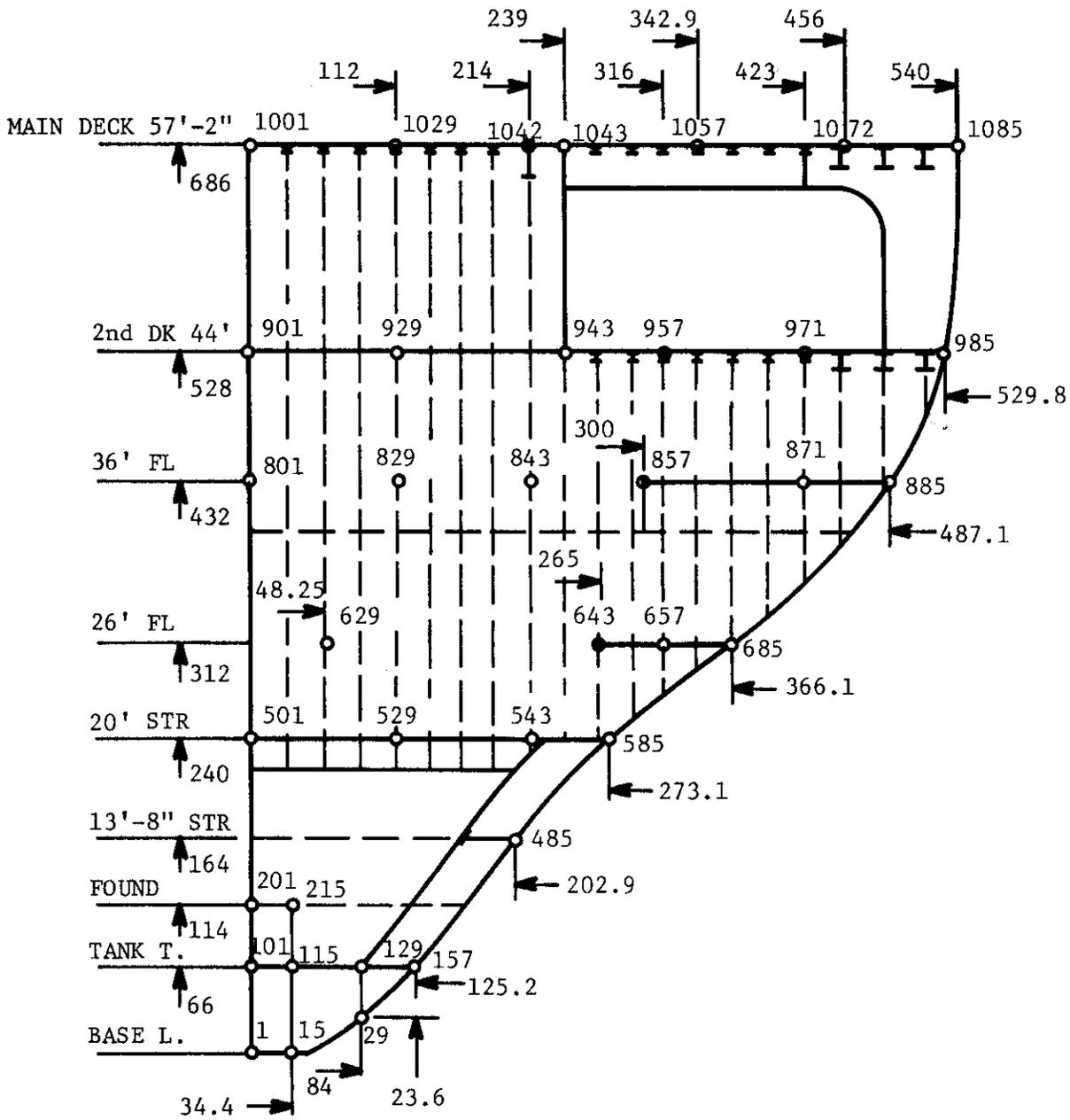
FIGURE 40. GRID POINTS ON FRAME 181,
