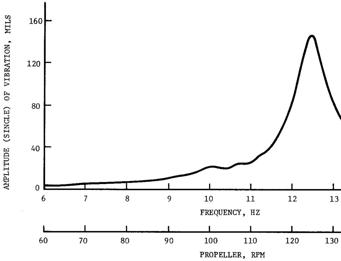
FIGURE 41. AMPLITUDE OF AXIAL MOTION AT THE PROPELLER
