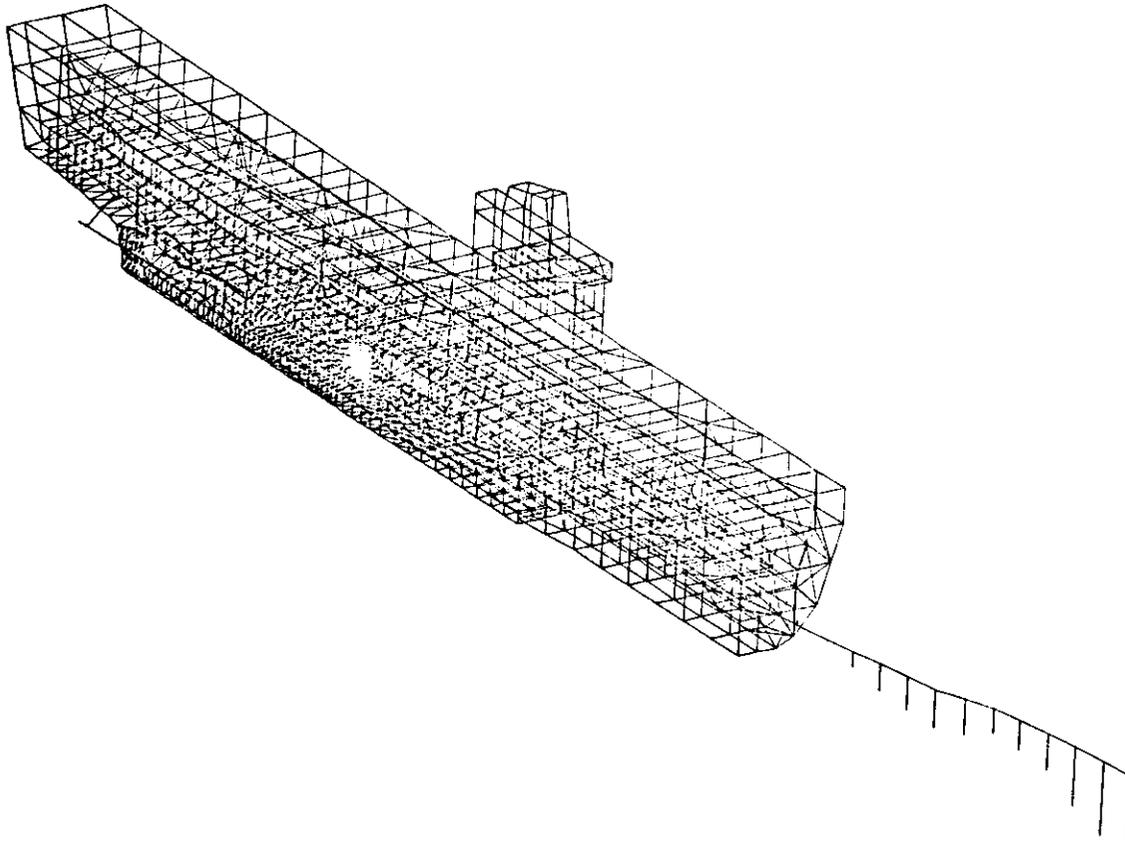
FIGURE 16. ISOMETRIC VIEW OF FINITE-ELEMENT MODEL
