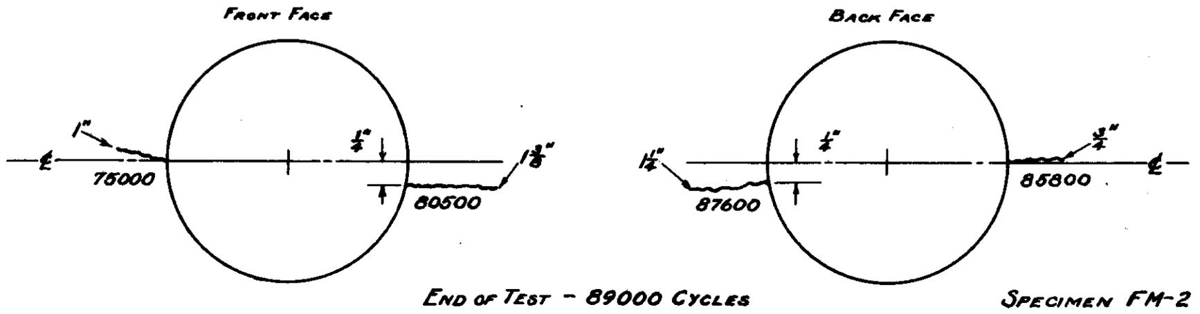
*LOCATION OF FATIGUE FAILURES* *SPECIMEN FM-2*
