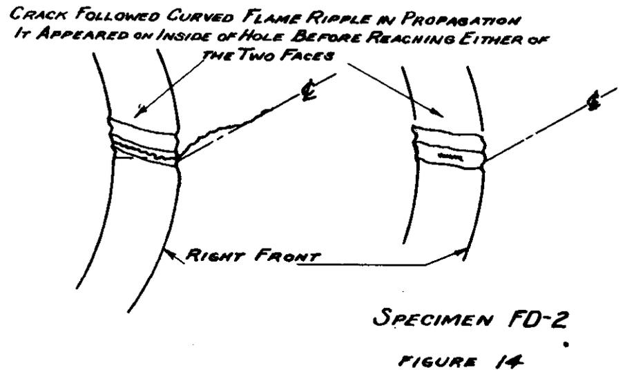
**LOCATION OF FATIGUE FAILURES**
