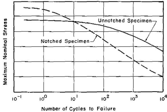
FIG. 1 TYPICAL S-N CURVES FOR CONSTANT-LOAD TESTS
