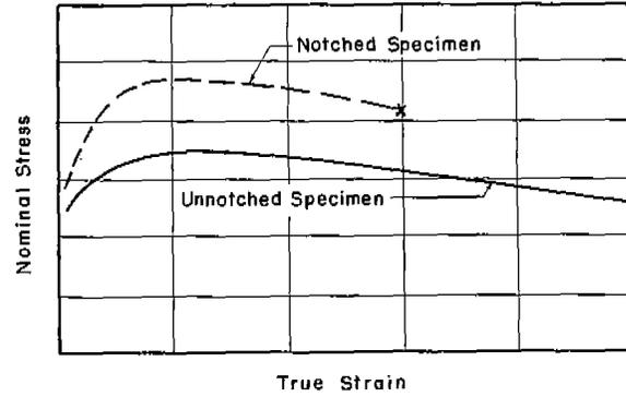
FIG. 2 TYPICAL STRESS-STRAIN CURVES
