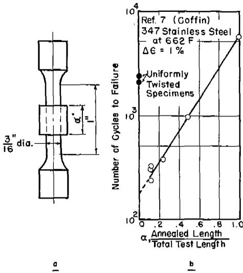
FIG. 6 COFFIN'S TEST DATA ON EFFECT OF NON-UNIFORM TEST MATERIAL
